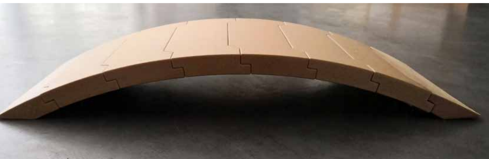
Een ge3Dprint model van een boogbrug met modules uit PLA met houtfragmenten. PLA is in de praktijk niet te gebruiken voor een brug in de buitenlucht.
